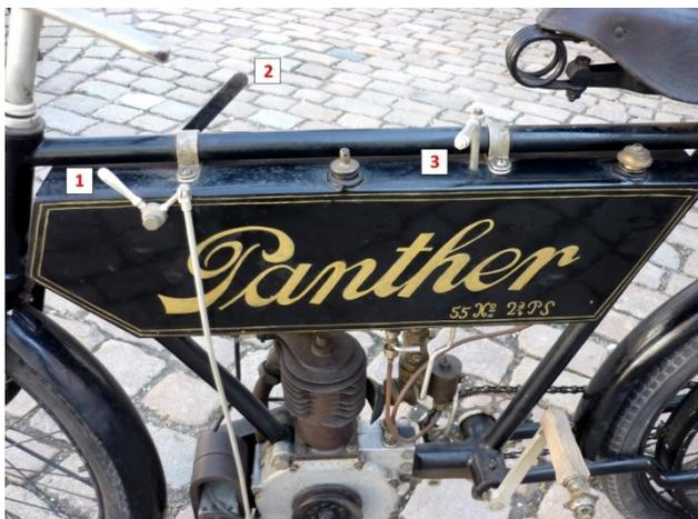
1) Zündverstellung; 2) Gashebel; 3) Luftklappe © Foto U. Schmidt
