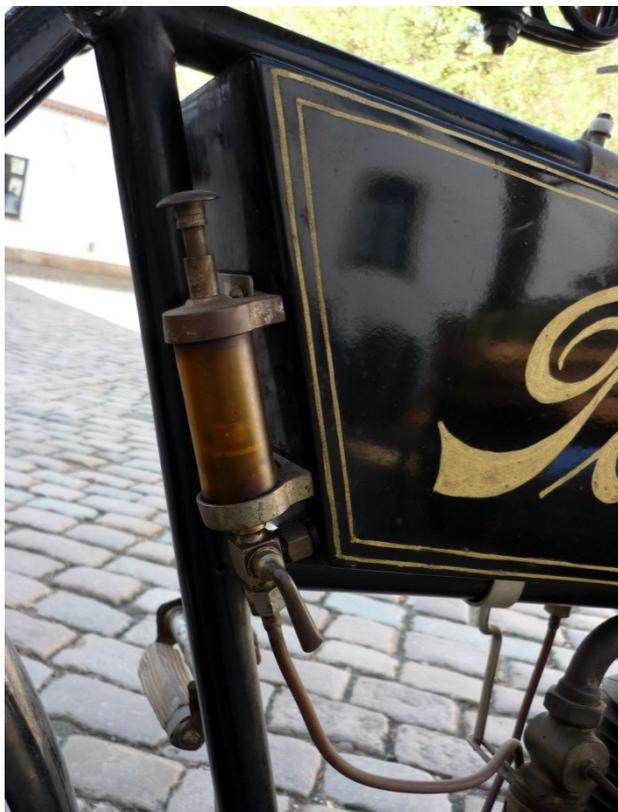
*Handpumpe für die Motorenschmierung © Foto U. Schmidt
